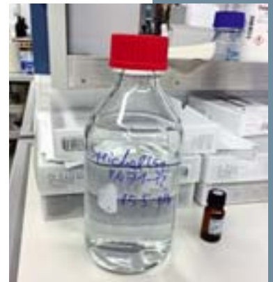
Prüft auf Speichelfestigkeit: Normspeichel nach DIN EN 71-12
